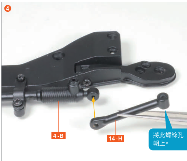
將連桿 (R) 14-H 的圓柱形螺絲孔朝上，並將另一側螺絲孔對準 4-B 前端的螺絲孔。
